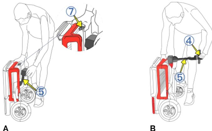
**A** Posizionare l'eFOLDi Lite verticalmente e rilasciare il piantone dello sterzo (5), premendo il fermo del telaio (7) e rilasciare completamente il piantone dello sterzo tenendo fermo il piantone dello sterzo (5).
